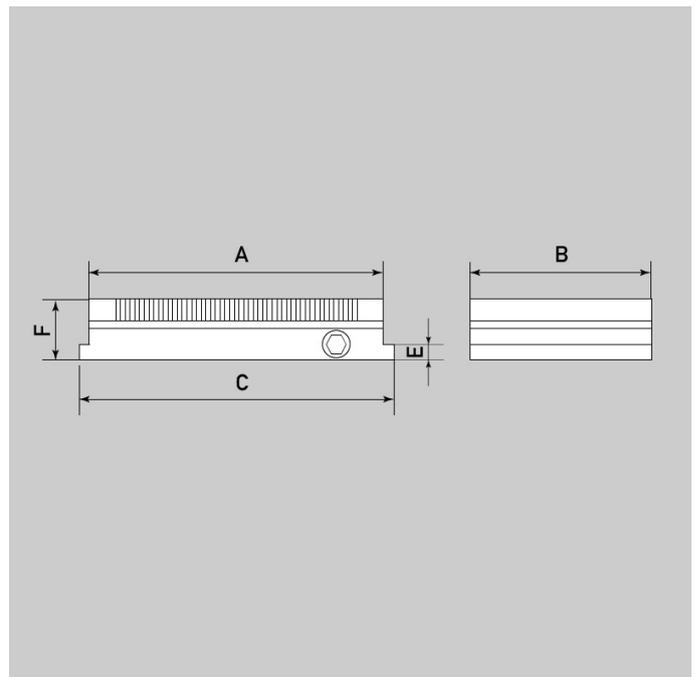
*Passo dei poli: 1,5 mm in acciaio / 0,8 mm in metallo non ferroso Forza di attrazione: max. 70 - 80 N/cm<sup>2</sup>*
