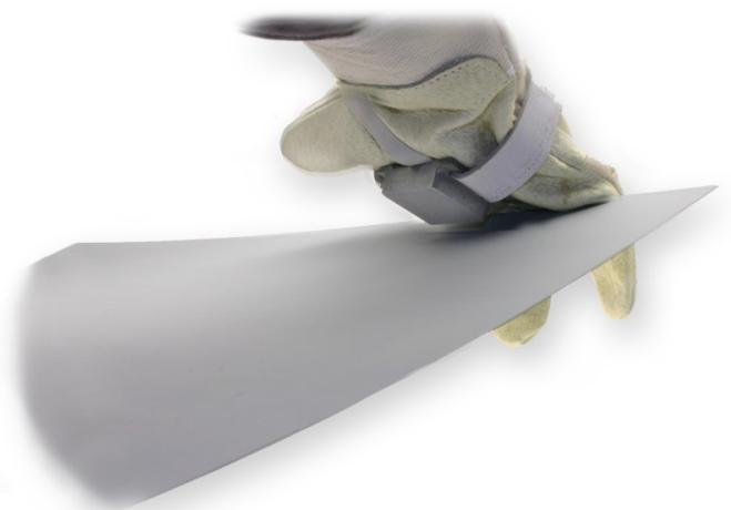
Magnete manuale con cinturino in pelle in due pezzi per disimpilare, afferrare e inserire lamiere e parti in lamiera da 0,3 a circa 2 mm
