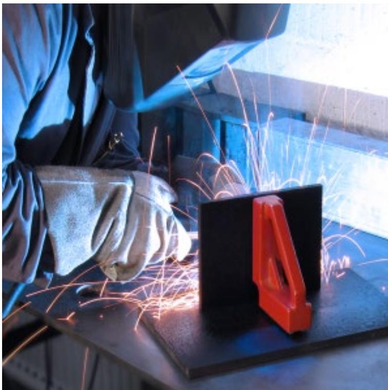
Le staffe di saldatura a magneti permanenti sono realizzate in tre diverse versioni:
