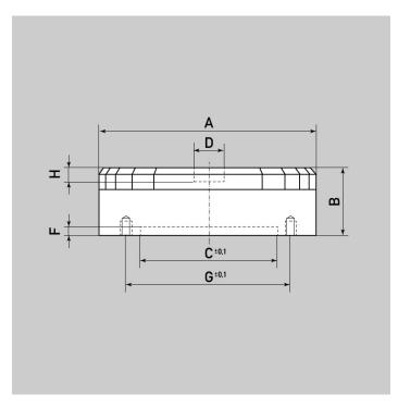
Un sistema magnetico ceramico particolarmente potente con un'elevata forza di attrazione distribuita uniformemente su tutta la superficie di serraggio magnetica ne garantisce l'utilizzo su torni e rettificatrici. Le scanalature di centraggio integrate facilitano l'allineamento dei pezzi.
