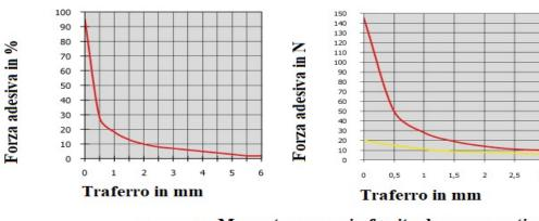
Magnete grezzo in ferrite dura magnetizzato assialmente Stesso magnete grezzo del sistema magnetico
